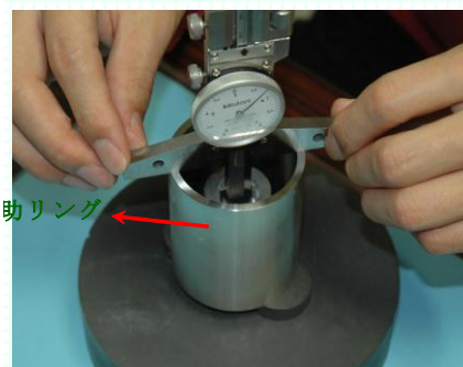
充填冶具を使用して粉詰めしているところ
